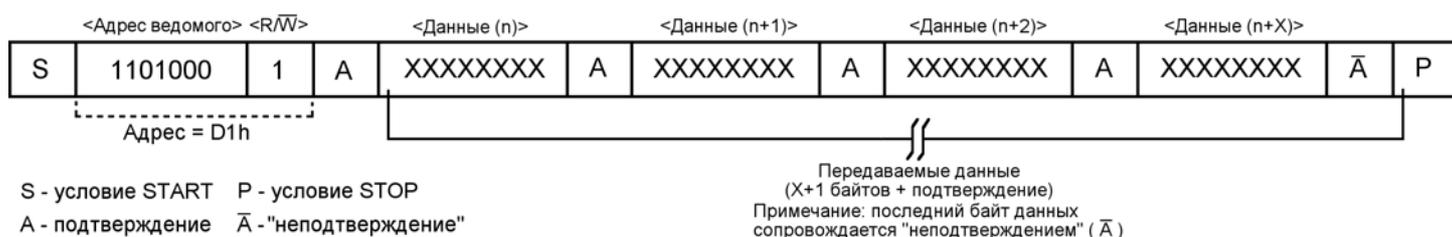
**Рис. 7.** Чтение данных – режим ведомого передатчика
