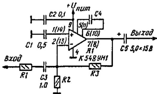
Инвертирующий линейный усилитель (рис. 2) позволяет избежать ограничения входного сигнала без дополнительной коррекции, если усиление по постоянному току равно или больше 10. Скорость нарастания выходного сигнала усилителя в таком включении составляет не менее 4В/мкс (при отсутствии внешнего корректирующего конденсатора). Коэффициент усиления по постоянному току определяется отношением сопротивлений резисторов цепи ООС R3 и R2
