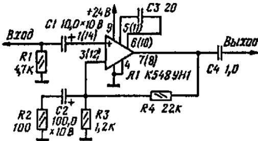
Микросхема в данном случае включена по схеме неинвертирующего усилителя с использованием одного транзистора дифференциального каскада, что, как уже говорилось, уменьшает уровень шумов.
