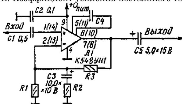
Максимальное сопротивление резистора R1 определяется при таком включении током базы 16 транзистора V2 (0,5 мкА) дифференциального каскада микросхемы: протекающий, через резистор ток должен быть, по крайней мере, в 10 раз больше базового тока. Учитывая, что напряжение на базе транзистора V2 должно быть таким же, как и на базе транзистора V4 этого каскада (а там оно составляет 1.3V), максимальное сопротивление резистора R1 рассчитывают по
