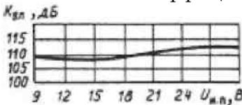
Зависимость коэффициента усиления по напряжению от напряжения питания.
