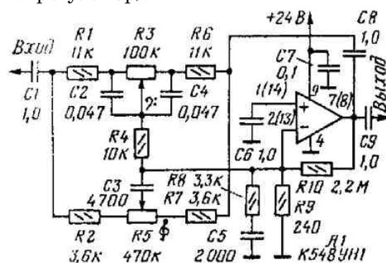
Диапазон регулирования тембра на частотах 40 и 16 000Гц первого из устройств +/-15 дБ, второго - не менее +/- 12 дБ. Коэффициент передачи обоих устройств, при установке движков резисторов в среднее положение равен 1.
