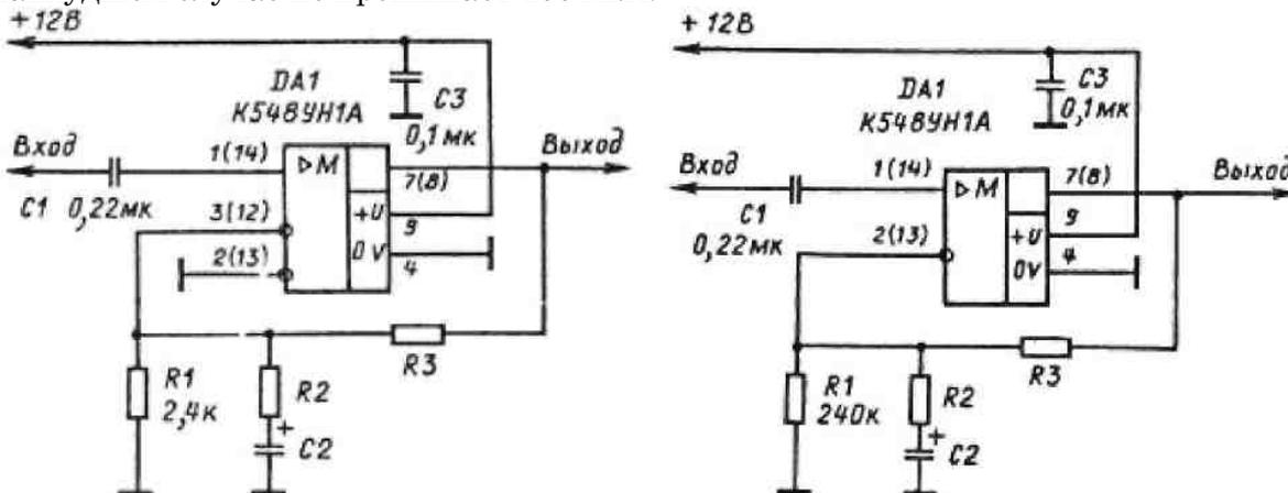
Типовая схема включения ИМС К548УН1 и Малошумящая схема включения ИМС К548УН1 Во втором случае режим работы входного каскада по постоянному току задается отрицательной обратной связью в виде резисторного делителя R1R3, средняя точка которого подключена к инвертирующему входу предусилителя (вывод 2 или 13). Чтобы обеспечить стабильность напряжения смещения ток через резистор R1 должен не менее чем в 10 раз превышать входной ток Iвх, который приблизительно равен 0,5 мкА.
