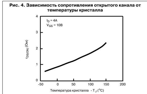
Положительный температурный коэффициент сопротивления означает, что работа МОП транзистора стабильна при колебаниях температуры и тем самым обеспечивается защита от перегрева и вторичного пробоя. Другим достоинством такой характеристики является возможность параллельного включения МОП транзисторов без опасения, что один прибор заберет на себя ток от других. Если один прибор начинает перегреваться, его сопротивление увеличивается и ток распределяется между другими, более холодными транзисторами.
