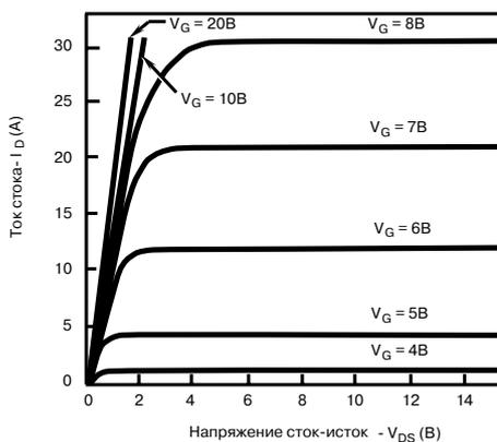
Поскольку частотный отклик МОП транзистора зависит от сопротивления и емкости затвора, можно сделать приближенную оценку предельной рабочей частоты из известных параметров транзистора.
