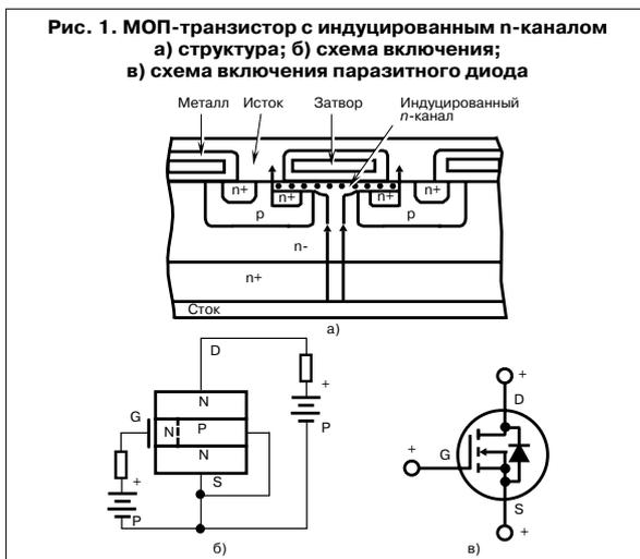
МОП транзистор является, управляемым напряжением прибором с высоким импедансом, в то время как биполярный транзистор это управляемый током прибор с низким импедансом. Как прибор, с переносом основных носителей заряда, МОП транзистор работает на больших частотах чем биполярный и в меньшей степени зависит от изменений температуры среды. Зависимость подвижности
